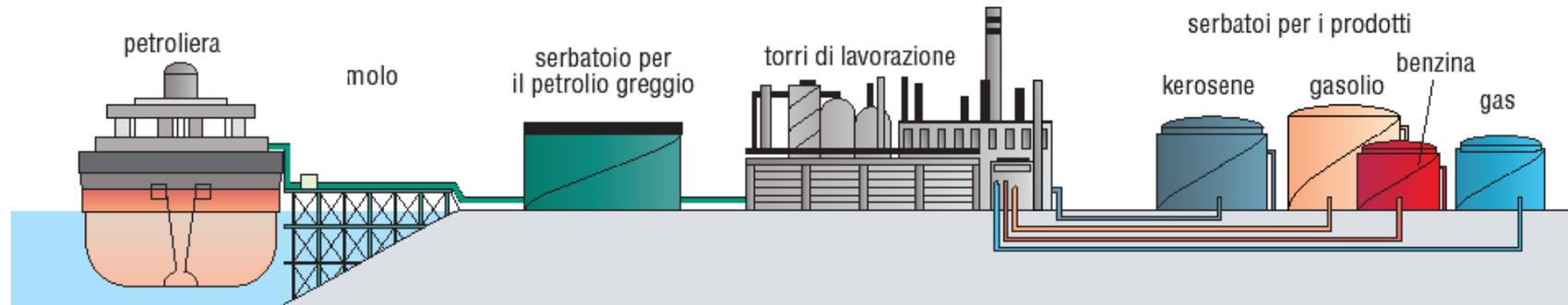
La raffineria è un grande impianto dove il greggio viene sottoposto alla *distillazione frazionata*. Infatti il petrolio è un miscuglio di idrocarburi liquidi (kerosene, benzina, gasolio) e gassosi (come il metano). Per separarli si usa la *distillazione* nella torre di distillazione.
